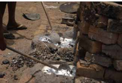
Arbeiten in Badeschuhen mit flüssigem Aluminium
